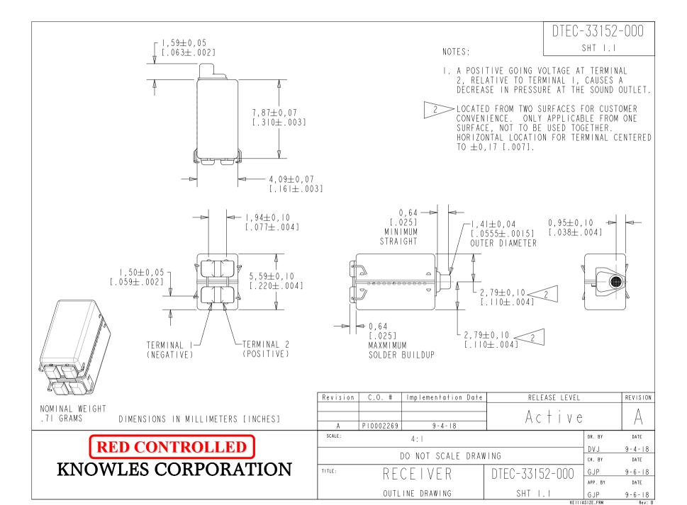
A PAIR OF MAGNETIC BALANCED ARMATURE RECEIVERS INTENDED FOR USE AS THE LOW FREQUENCY DRIVER IN A HI-FI SYSTEM.
